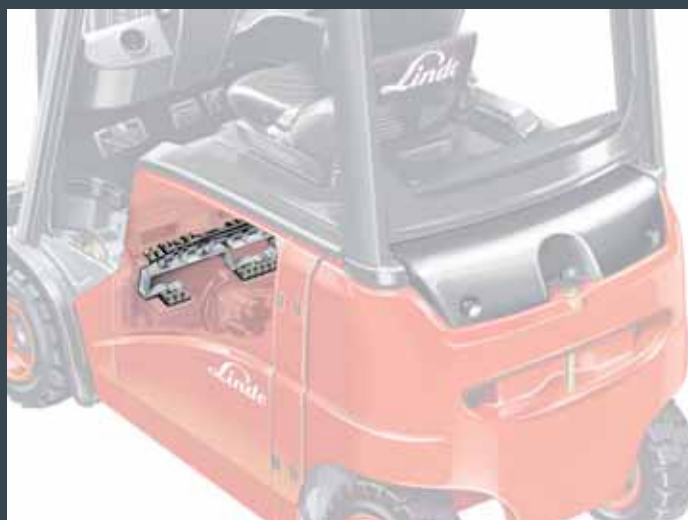
Grazie all'innovativo assale di trazione vengono a mancare completamente i cavi di corrente. Questa innovazione garantisce ridotto consumo di energia e costituisce il fondamento per la migliore conducibilità elettromagnetica.
