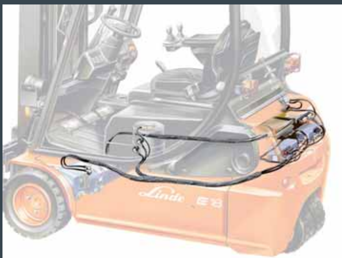
Carrello elettrico tradizionale con circa 33 mt di cavi di corrente.
