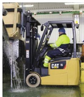
La Protezione Ingresso dall'acqua, **Protezione dalle Intemperie IPx4**, della gamma da 48 V, permette di effettuare operazioni in ambienti esterni o in ambienti contaminati.
